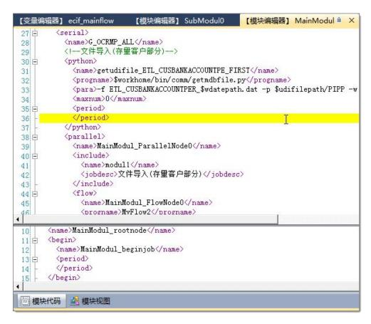
上图示例了一个模块的部分代码,可以看出模块块代码设计器是一个标准的文本编辑工具。具有"拷贝"、"剪切"、"粘贴"、"撤销"、"重做"等文本操作。还具有"关键字高亮","行号","缩进","格式化文本","代码注释"等传统高级语言编程工具的特征。可以对代码窗口进行拆分,方便随时参考。
