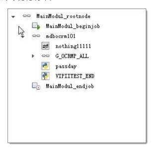
如上图所示:由 root 节点作为根节点,begin 节点作为起始节点,end 节点作为结束节点,把用户自定义作业通过串并组等系统缺省节点,按照 TASKCTL 定义的一系列规则来构成节点树。以下是模块设计在节点树上的设计规则:
