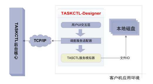
通过上图了解到,本开发平台除了能通过调度服务器适配器以TCP/IP协议的方式与TASKCTL后台核心服务器通讯外。还集成了TASKCTL服务模拟器组件,直接进行本地开发。
