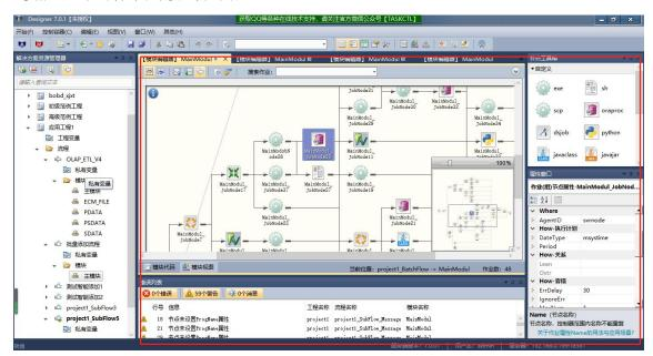
通过拖拽节点工具箱作业类型组件到图形节点位置或节点关系数据,以及对节点属性框里属性的编辑,来实现对模块的可视化设计模块。也可以随时切换到模块代码设计窗口,直接通过编码的方式来完成模块的代码设计模块。
